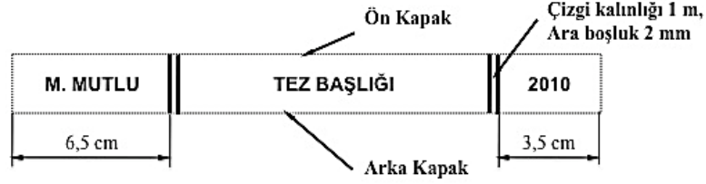
Şekil 2.3: Bez cilt dış kapak sırtının düzeni ve boyutları.
